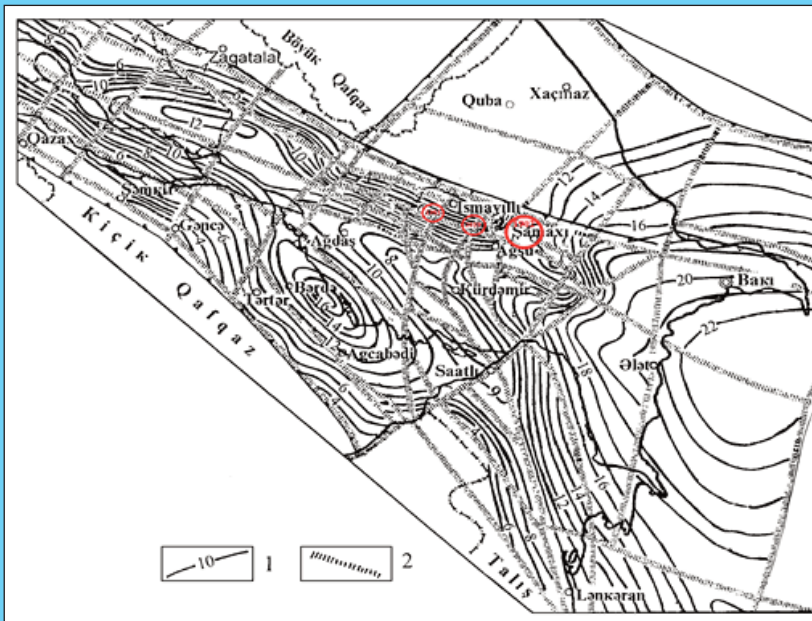
Şəkil 6. Bünövrə səthinin relyef xəritəsində zəlzələlərin təsviri [3]. 1-Bünövrə səthinin relyefinin izoxətləri; 2-regional tektonik qırılmalar.
